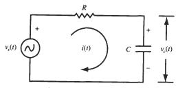
Fig. 1-32 RC circuit.
